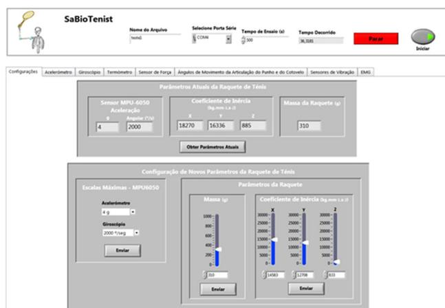
Figura 1. Janela de configuração dos parâmetros da raquete de ténis e do sensor MPU-6050.
