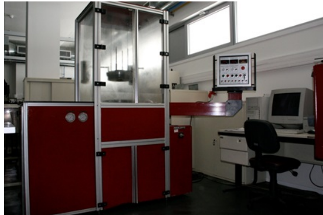
Figura 2: Sistema experimental para realização do ensaio hidráulico de expansão biaxial.
