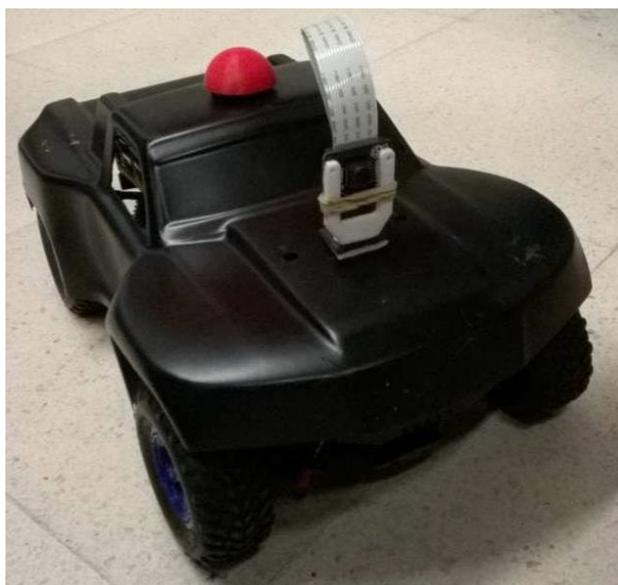
Figura 39 – RC com câmara acoplada
