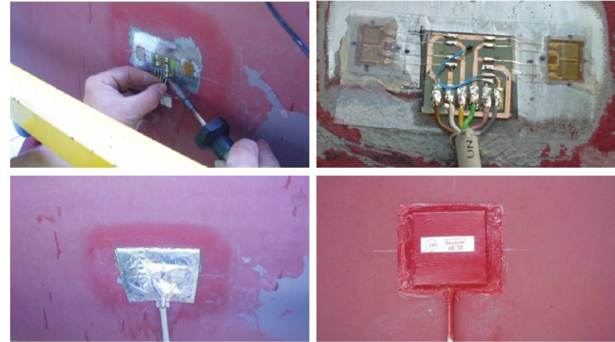
Instrumentação do tabuleiro com os extensómetros e termistores
