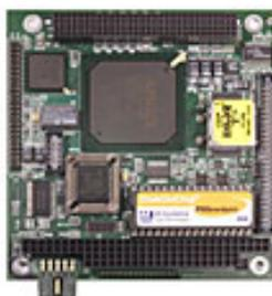
fig. 7-15 – um 'PC in a board' Bobcat da Versallogic
