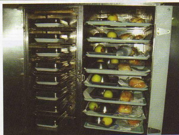
Figura 7 • Veículo de transporte de refeições com compartimentos para refeições quentes e frias.
