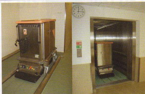
Figura 6 • AGV a elevar o compartimento (esquerda) e a sair do elevador (direita).
