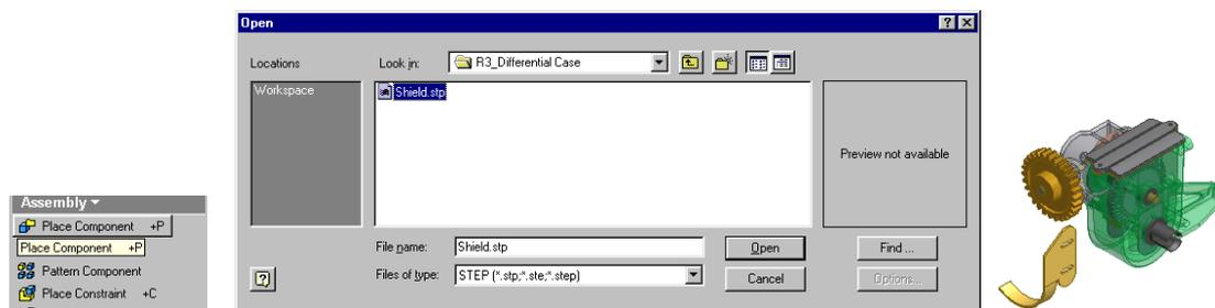
Para inserir o componente no formato STEP, selecione a opção **Place Component**. Na célula **Files of type** selecione o formato **STEP**. Selecione o ficheiro **Shield.stp**. Posicione-o no local indicado.
