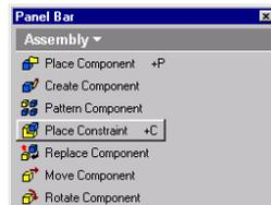
Selecione a opção Place Constraint. Abre-se uma janela que permite posicionar os componentes
