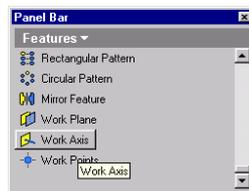
Selecione o comando Work Axis. É possível que tenha de usar a barra de deslizamento à direita na janela para ir para os comandos que se encontram no fim da lista.
