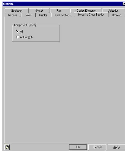
Na janela que se abre seleccione o separador **Modeling Cross Section**. E em **Component Opacity** seleccione **All**. Faça **Ok**. No passo seguinte vamos sectionar a máquina para podermos visualizar o seu interior.
